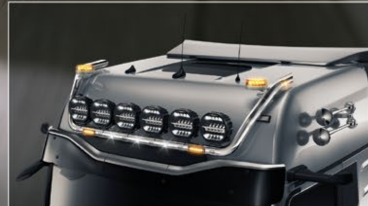
21706-4-P /-B - LightFix - SKY-LIGHT "WILDLIFE" Ekstralysbøyle for maksimalt 6 ekstralys og 2 rotorblinklys Rustfritt stål - polert eller sort pulverlakkert - Ø 70mm - montert kabel inkl. rød LED på enden av røret
