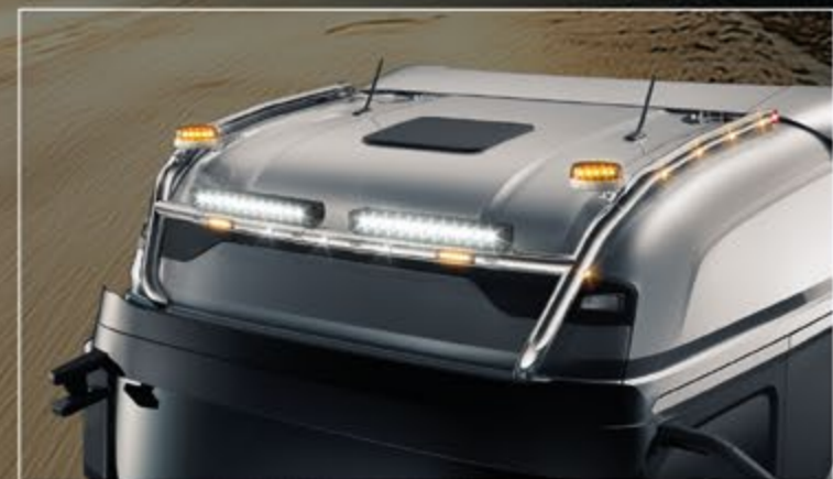
22701-5-P /-B - LightFix - SKY-LIGHT "H-MAX" Dachlampenbügel für maximal 6 Scheinwerfer und 2 Kennleuchten Edelstahl - hochglanzpoliert oder schwarz pulverbeschichtet - Ø 70mm - Kabelsatz inkl. roten LEDs in den Rohrenden und 6 orangen LEDs an den Seiten
