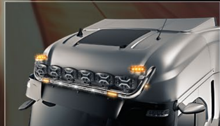
27705-3-P /-B - LightFix - SKY-LIGHT "U" Dachlampenbügel für die Montage von max. 6 Scheinwerfern und 2 Kennleuchten Edelstahl - hochglanzpoliert oder schwarz pulverbeschichtet - Ø 70mm - mit Kabelsatz
