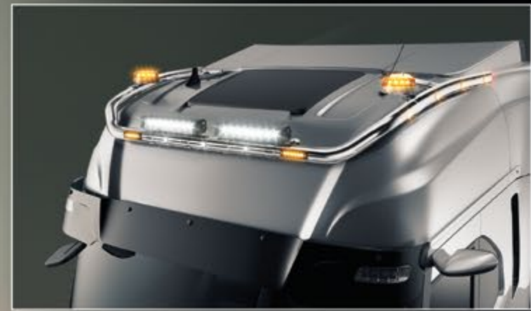
27705-8-P /-B - LightFix - SKY-LIGHT "WILDLIFE" Dachlampenbügel für die Montage von max. 6 Scheinwerfern und 2 Kennleuchten Edelstahl - hochglanzpoliert oder schwarz pulverbeschichtet - Ø 70mm - mit Kabelsatz inkl. roten LEDs in den Rohrenden und orangen LEDs an den Seiten
