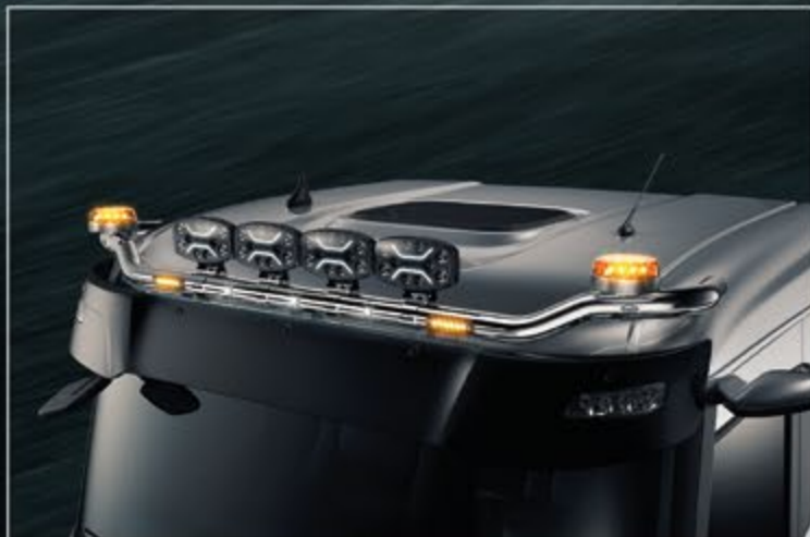
27706-1-P /-B - LightFix - SKY-LIGHT "WING" Dachlampenbügel für die Montage von max. 6 Scheinwerfern und 2 Kennleuchten Edelstahl - hochglanzpoliert oder schwarz pulverbeschichtet - Ø 70mm - mit Kabelsatz
