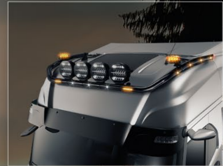
27705-8-P /-B - LightFix - SKY-LIGHT "WILDLIFE" Dachlampenbügel für die Montage von max. 6 Scheinwerfern und 2 Kennleuchten Edelstahl - hochglanzpoliert oder schwarz pulverbeschichtet - Ø 70mm - mit Kabelsatz inkl. roten LEDs in den Rohrenden und orangen LEDs an den Seiten
