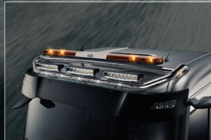
27706-4-P - LightFix - SKY-LIGHT + SKY-BRIDGE Dachlampenbügel mit Querrohr für max. 6 Scheinwerfer und einen Warnbalken Edelstahl - hochglanzpoliert - Ø 70mm - mit Kabelsatz
