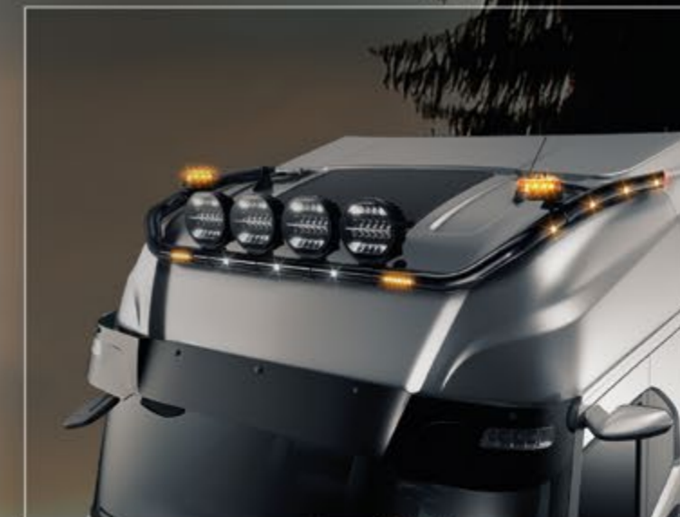
27705-8-P /-B - LightFix - SKY-LIGHT "WILDLIFE" Lygtebøjle til montering af maksimalt 6 ekstra lygter og advarselslygter. Rustfrit stål - Poleret eller sort pulverlakeret - Ø 70mm - Færdigtrukket kabel. Rød LED i enden af røret samt gule LED'er på siderne.
