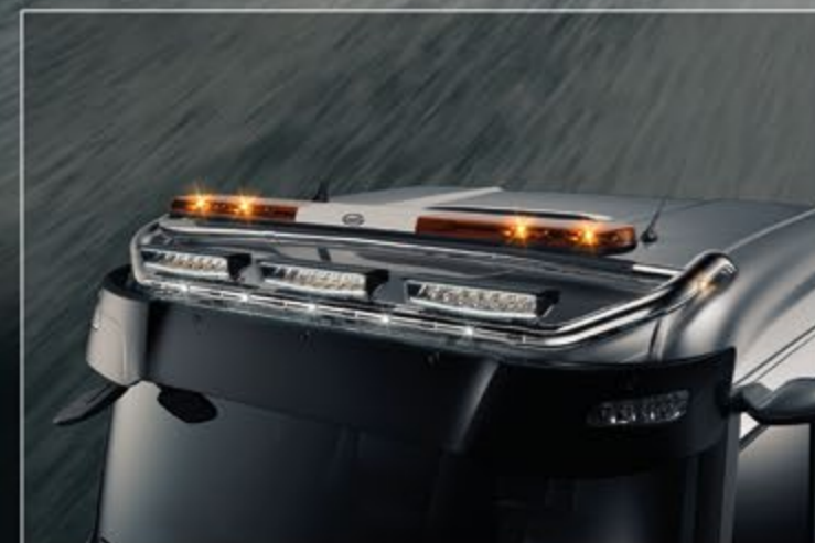
27706-4-P - LightFix - SKY-LIGHT + SKY-BRIDGE Lygtebøjle til montering af maksimalt 6 ekstra lygter samt lygtebro. Rustfrit stål - Poleret - Ø 70 mm - Færdigtrukket kabel.
