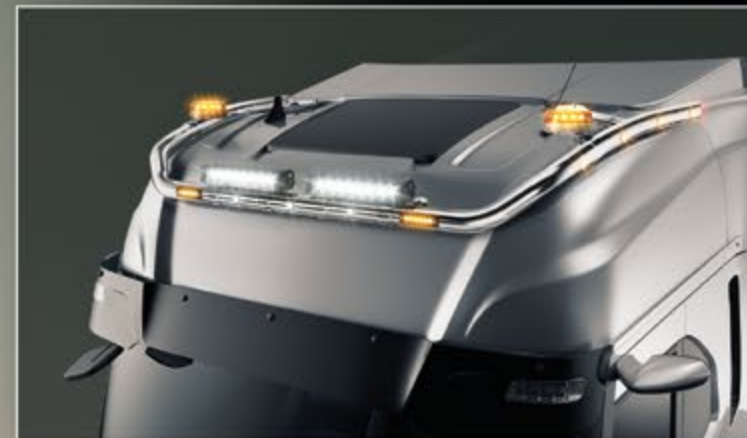
27705-8-P /-B - LightFix - SKY-LIGHT "WILDLIFE" Lygtebøjle til montering af maksimalt 6 ekstra lygter og advarselslygter. Rustfrit stål - Poleret eller sort pulverlakeret - Ø 70mm - Færdigtrukket kabel. Rød LED i enden af røret samt gule LED'er på siderne.
