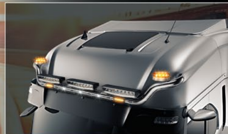
27705-4-P /-B - LightFix - SKY-LIGHT "WING" Lygtebøjle til montering af maksimalt 6 ekstra lygter og advarselslygter. Rustfrit stål - Poleret eller sort pulverlakeret - Ø 70mm - Færdigtrukket kabel.
