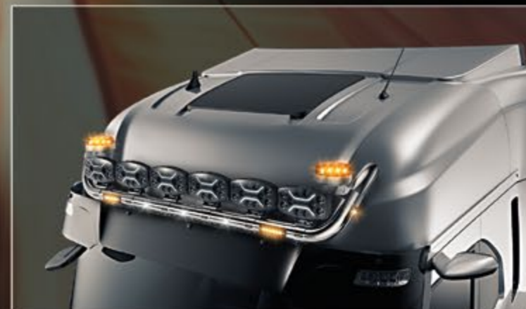
27705-3-P /-B - LightFix - SKY-LIGHT "U" Lygtebøjle til montering af maksimalt 6 ekstra lygter og advarselslygter. Rustfrit stål - Poleret eller sort pulverlakeret - Ø 70mm - Færdigtrukket kabel.
