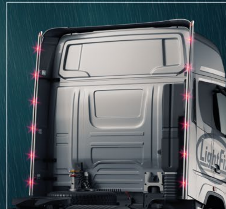
22748-1-P/-B - LightFix - CAB-LINER RVS stalen beugel - set voor linker en rechter zijde gepolijst of zwart gepoedercoat - Ø 60mm - voorzien van bekabeling incl. rode LEDs waarvan 2 in de uiteinden
