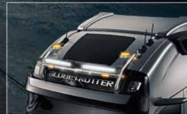
TLG23704-4-P /-B - LightFix - SKY-LIGHT "H-TYPE" TLG23704-5-P /-B - LightFix - SKY-LIGHT "H-TYPE" Globetrotter (TLG23704-4-P /-B) / Globetrotter XL/XXL (TLG23704-5-P) Dachlampenbügel für max. 6 Scheinwerfer und 2 Kennleuchten Edelstahl - hochglanzpoliert oder schwarz pulverbeschichtet Ø 70mm - mit Kabelsatz
