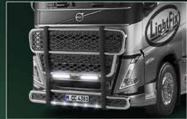
TLG23760-2-P /-B - LightFix - FRONT-PROTECT "BIG NORDIC" - FH TLG23761-2-P /-B - LightFix - FRONT-PROTECT "BIG NORDIC" - FM Frontschutzgrill aus Edelstahl inkl. schwarzem Schutznetz aus ABS hochglanzpoliert oder schwarz pulverbeschichtet - Ø 70mm - Kabelsatz TLG29708-1-P /-B - LightFix - LAZER-BRIDGE für Lazer Triple-R 1000
