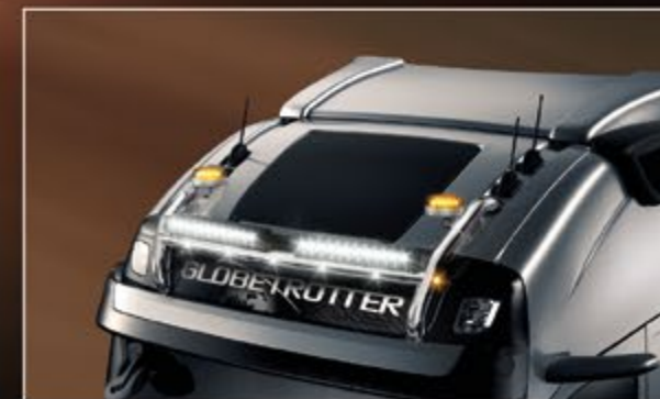
TLG23704-4-P /-B - LightFix - SKY-LIGHT "H-TYPE" TLG23704-5-P - LightFix - SKY-LIGHT "H-TYPE" Globetrotter (TLG23704-4-P /-B) / Globetrotter XL/XXL (TLG23704-5-P) Ekstralysbøyle for maksimalt 6 ekstralys og 2 rotorblinklys Rustfritt stål - polert eller sort pulverlakkert Ø 70mm - montert kabel
