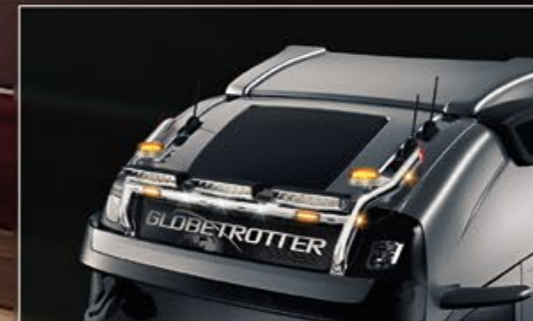
TLG23704-7-P /-B - LightFix - SKY-LIGHT "WILDLIFE" TLG23704-8-P /-B - LightFix - SKY-LIGHT "WILDLIFE" Globetrotter (TLG23704-7-P /-B) / Globetrotter XL/XXL (TLG23704-8-P /-B) Ekstralysbøyle for maksimalt 6 ekstralys og 2 rotorblinklys Rustfritt stål - polert eller sort pulverlakkert Ø 70mm - montert kabel inkl. rød LED på enden av røret
