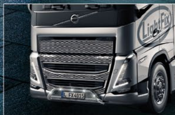
TLG23740-2-P /-B - LightFix - FRONT-LINER "TARGA" - FH LED-Lysbøyle i rustfritt stål med underkjøringsbeskyttelse polert eller sort pulverlakkert - Ø 60mm inkl. 5 hvite LED
