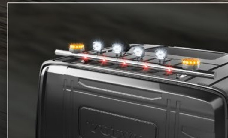
TLG23715-2-P /-B - LightFix - REAR-LIGHT Sovhytt / Globetrotter uten takspoiler Lysbøyle for maksimalt 4 arbeidslys og rotorblinklys Rustfritt stål - polert eller sort pulverlakkert - Ø 70mm - montert kabel
