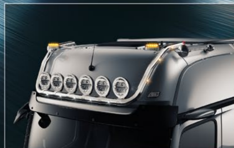
25707-3-P /-B - 25707-4-P /-B - LightFix - SKY-LIGHT "V-TYPE" Big Space (25707-3-P /-B) / Giga Space (25707-4-P /-B) Dachlampenbügel für maximal 6 Scheinwerfer und Kennleuchten Edelstahl - hochglanzpoliert oder schwarz pulverbeschichtet - Ø 70mm - Kabelsatz inkl. roten LEDs in den Rohrenden
