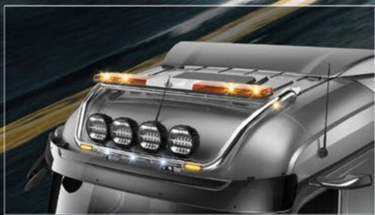
25705-8-P /-B - 25705-9-P /-B - LightFix - SKY-LIGHT + SKY-BRIDGE Stream Space 2300 (25705-8-P /-B) / Stream Space 2500 (25705-9-P /-B) Dachlampenbügel mit Querrrohr für maximal 4 Scheinwerfer und einen Warnbalken Edelstahl - hochglanzpoliert oder schwarz pulverbeschichtet - Ø 70mm - Kabelsatz
