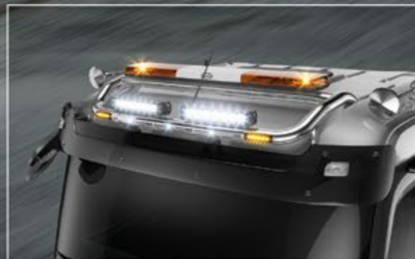
25704-8-P /-B - LightFix - SKY-LIGHT + SKY-BRIDGE Dachlampenbügel mit Querrrohr für maximal 4 Scheinwerfer und einen Warnbalken Edelstahl - hochglanzpoliert oder schwarz pulverbeschichtet Ø 70mm - Kabelsatz
