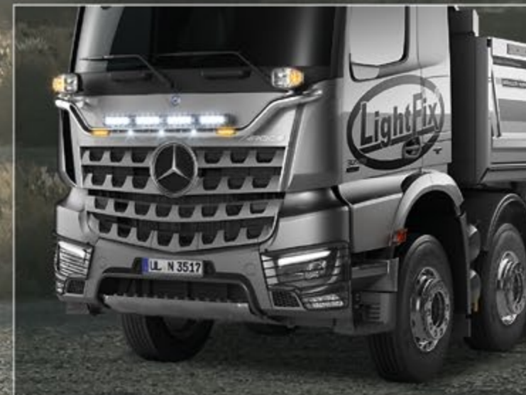
25750-2-P /-B - 25750-3-P /-B - LightFix - PLOW-LIGHT Arocs 2300 (25750-2-P /-B) / Arocs 2500 (25750-3-P /-B) Lampenbügel für max. 4 Scheinwerfer und 2 Hauptscheinwerfer Edelstahl - hochglanzpoliert oder schwarz pulverbeschichtet - Ø 70mm - Kabelsatz geeignet für Schneepflüge und Kommunalfahrzeuge
