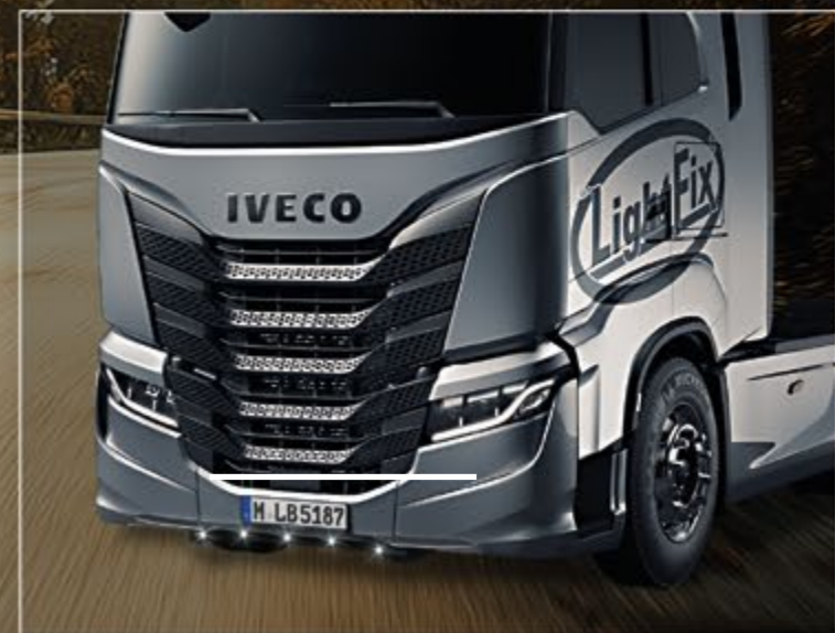
27741-2-P /-B - LightFix - FRONT-LINER "TARGA MINI" Orurowanie lamp LED ze stali nierdzewnej polerowana lub czarny - Ø 60mm - z okablowaniem w zestawie białe diody LED z przodu
