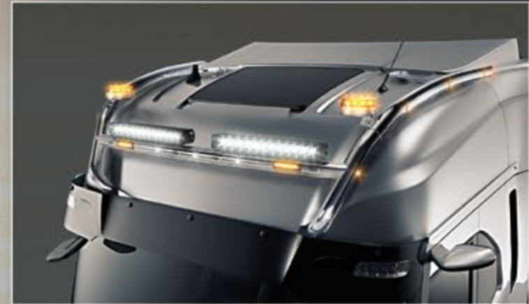
27705-5-P /-B - LightFix - SKY-LIGHT "MAX" Rama dachowa do montażu maksymalnie 6 reflektorów i lampy sygnalizacyjne Stal nierdzewna - polerowana lub czarny - Ø 70mm - z okablowaniem czerwone LED na końcówkach rury i pomarańczowe LED zintegrowane po bokach
