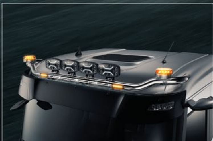
27706-1-P /-B - LightFix - SKY-LIGHT "WING" Rama dachowa do montażu maksymalnie 6 reflektorów i lampy sygnalizacyjne Stal nierdzewna - polerowana lub czarna - Ø 70mm - z okablowaniem
