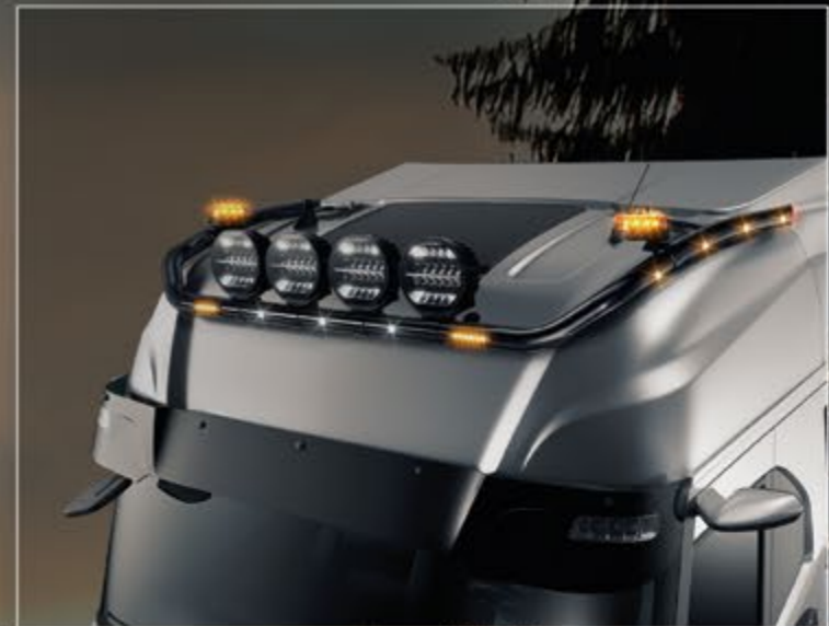
27705-8-P /-B - LightFix - SKY-LIGHT "WILDLIFE" Rama dachowa do montażu maksymalnie 6 reflektorów i lampy sygnalizacyjne Stal nierdzewna - polerowana lub czarny - Ø 70mm - z okablowaniem czerwone LED na końcówkach rury i pomarańczowe LED zintegrowane po bokach
